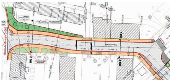
Die Asphaltdecke der Krausenstraße ist brüchig, der Gehweg mit Platten uneben und teilweise lose. Da muss was passieren, und das tut es in diesem Jahr auch. In zwei Bauabschnitten wird die Krausenstraße auf 267 Metern generalüberholt, Start für die Maßnahme ist im März mit dem ersten Bauabschnitt.
