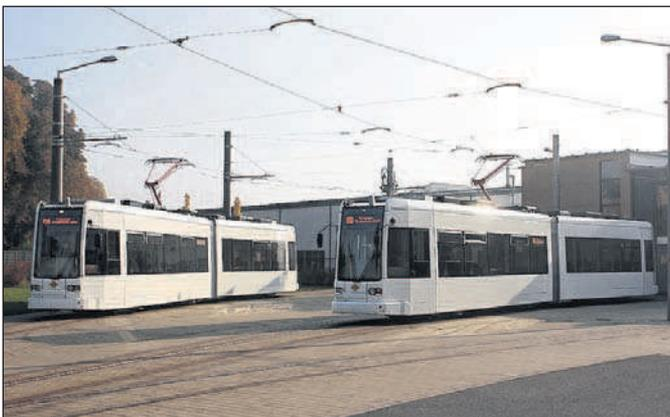
Die neuen Straßenbahnen der PSB GmbH sind mit Niederflurbereichen ausgestattet, die ein leichteres Ein- und Aussteigen ermöglichen. Realisiert wird dies durch geringe Einstieghöhen sowie durch zwei Mehrzweckbereiche an den Türen 2 und 3, die ohne Stufen begehbar und befahrbar sind. Entsprechend können Fahrgäste mit Kinderwagen, ältere Bürger sowie mobilitätseingeschränkte Fahrgäste diese Bereiche ohne größere Hürden betreten oder verlassen.
