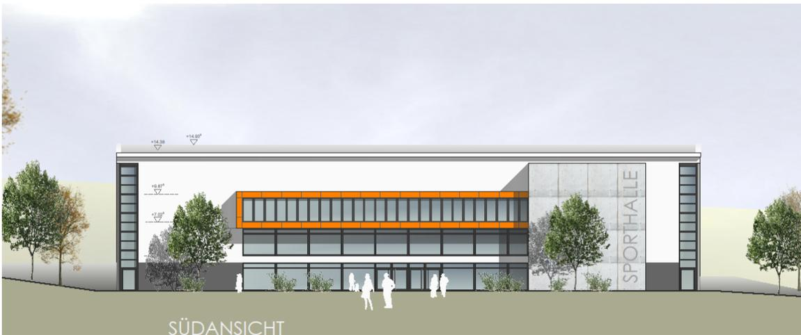
Das Gebäude wird als kompakter Baukörper errichtet. Alle notwendigen Gebäudeteile sind integriert. Die Sporthalle erhält ein Flachdach und teilweise begrünte Fassaden. Die Erschließung erfolgt für die Sportler über die Chamissostraße und für die Zuschauer und Gäste über die Reißiger Straße.
